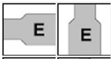
Los ensanches de sección son elementos de la red de distribución de aire que unen conductos adyacentes de distinta sección.
